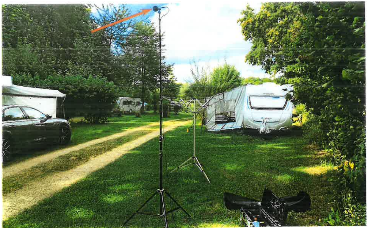
Foto 12: Blick auf das am Immissionsmessort IO 1 „Campingplatz Sternberg“ in h = 2,5 m Höhe über Gelände installierte Messmikrofon (Pfeil).
