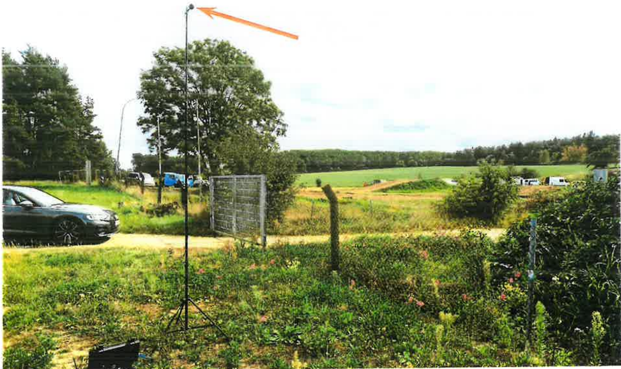
Foto 14: Blick auf das am Ersatzmessort EMO (NW-Ecke der Motorsportanlage des MC Sternberg e.V.) in h = 4 m Höhe über Gelände installierte Messmikrofon (Pfeil).
