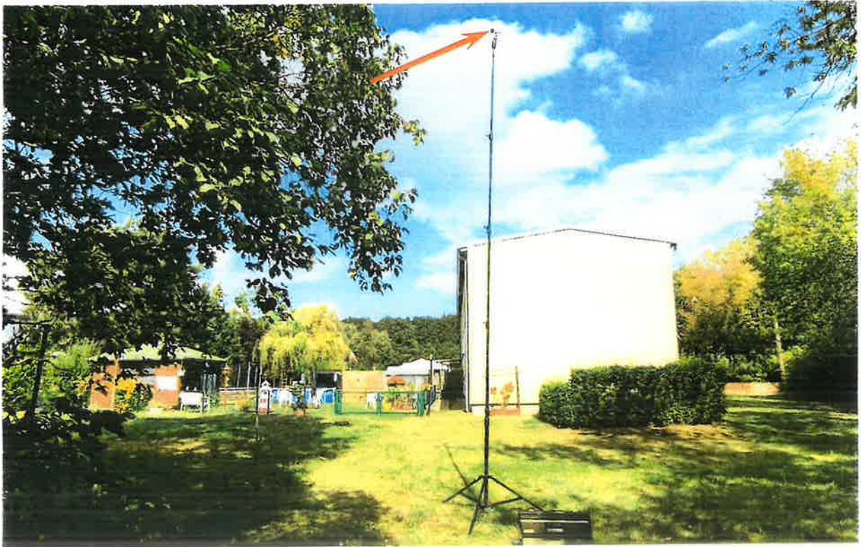
Foto 13: Blick auf das am Immissionsmessort IO 2 „Brüeler Chaussee 17“ in h = 6 m Höhe über Gelände installierte Messmikrofon (Pfeil).
